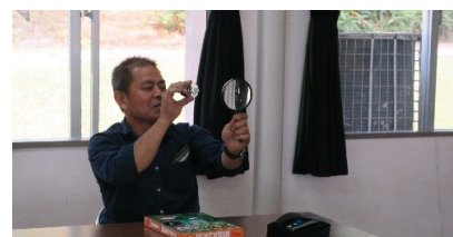
望遠鏡の仕組み これだと像が逆に見えます。
